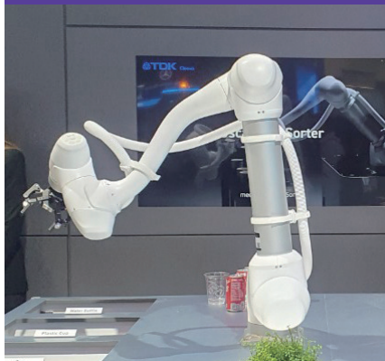
두산- 집계를 사용하여 자원의 성질을 분류하고 적합한 위치로 옮길 수 있는 로봇팔 기반 분리수거 기계 ‘오스카더스터’
